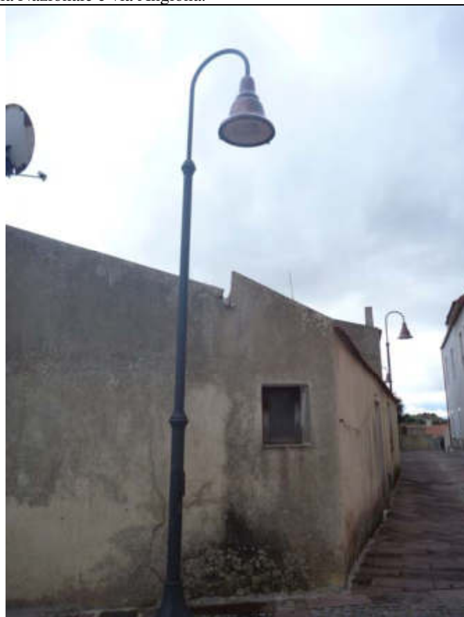
Foto n° 2 – Illuminazione su palo d'arredo e corpo illuminante a norma per l'inquinamento luminoso in centro storico (2004-200). Tipologia proponibile per via Roma alta e zona Funtana.
